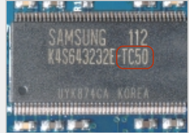
BELLEK FREKANSI: Bellek chip'i üzerindeki "TC 50" ifadesi 5,0 nanosaniyeyi ifade eder. Bu değer bazen "TQ" ile de gösterilir.
