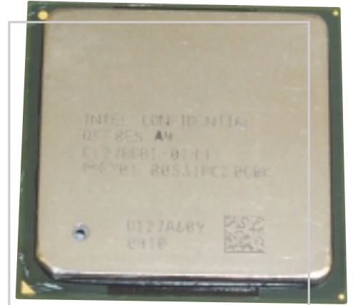
MPGA 478 Yapı: 478 pinlik yeni P4'lerin minyatür yapısı 2 GHz üzeri modellerde de korunacak.
