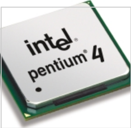
YENİ DİŞ YAPISI: P4'ler 478 ve 423 pin olmak üzere iki farklı dış yapıyla üretiliyor. 2 GHz'in üstü P4'ler ise sadece 478 pin olacak.
