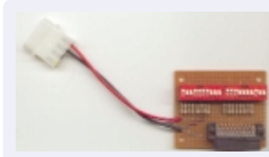
İlk nesil AMD Athlon işlemcilerin çarpan değerlerini Golden Finger denilen resimdeki ufak devreciklerle değiştirebiliyoruz.
