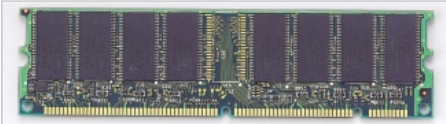
SD-RAM: Sistem frekansı ile senkronize bir şekilde çalışan bu bellek türü günümüzde en yaygın olarak kullanılan RAM teknolojisi.
