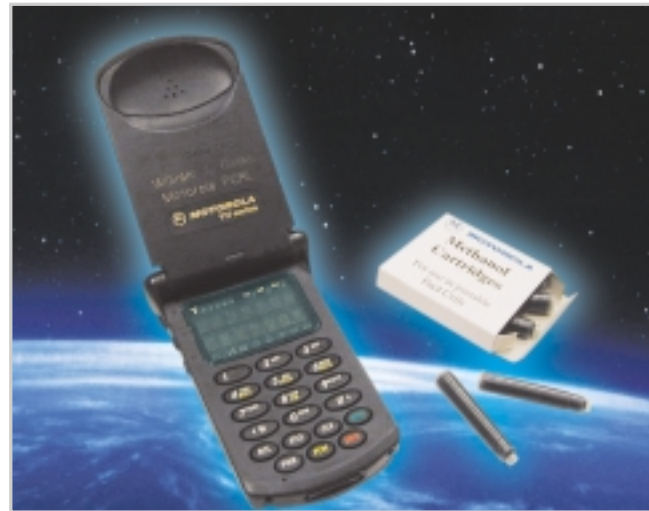
KÜÇÜK FİŞEKLER: Akaryakıt hücrelerini sonradan yüklemek için kullanılan metanol kartuşları neredeyse dolmakalem mürekkep kartuşu büyüklüğündeler.
