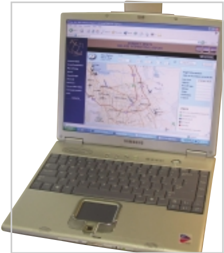
ÜÇÜ BİR ARADA: Banias işlemcisi, i855 chipseti ve 802.11b WLAN bileşenlerinin entegrasyonu Centrino'yu oluşturuyor.
