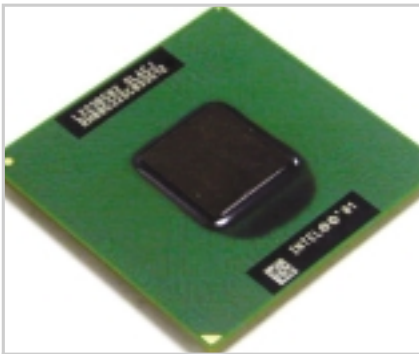
MOBİL PC SİSTEMLERİ İÇİN: Banias işlemcisi düşük güçte yüksek performans sağlıyor.
