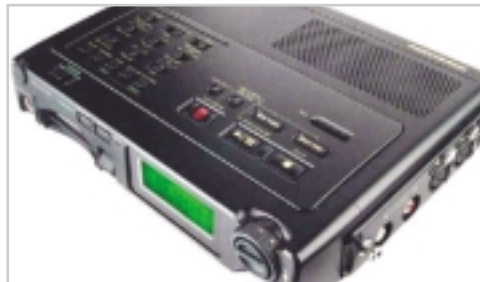
MEKANIĞE ELVEDA: Marantz'ın taşınabilir profesyonel kayıt cihazı PMD690, kayıt ortamı olarak CompactFlash ya da Microdrive kullanıyor.
