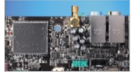
Entegre W-LAN: Asus, harici erişim noktası ürünü ile W-Lan desteği sağlayan tek katılımcı.
