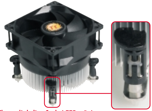
Thermaltake'ten Socket 775 soğutucu: Klipsli bağlantı sayesinde kolayca takılıp çıkartılabilir.
