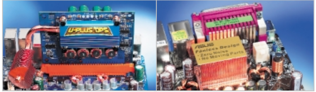
Daha fazla soğutma: Yeni P4 işlemcilerinin aşırı güç (120 Watt) tüketmelerinden dolayı bir o kadar da ısınıyorlar. Çözüm, gerilim denetçilerini soğutmaktan geçiyor, tıpkı 8ANXP-D ve P5AD2'de olduğu gibi.
