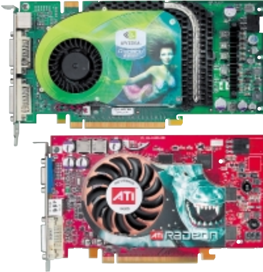
PCIe-x16 kartlarında boyut farkı: ATI'nin X800T referans kartı Nvidia'nın GeForce 6800 GT'sinden daha küçük olmasına karşın daha iyi bir performansa sahip.
