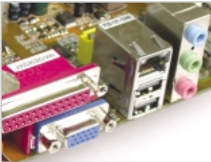
Hepsi bir arada: Ekran kartı, ses kartı, Ethernet, Firewire ve USB teknolojileri oldukça ince bir tasarımla içiçe.
