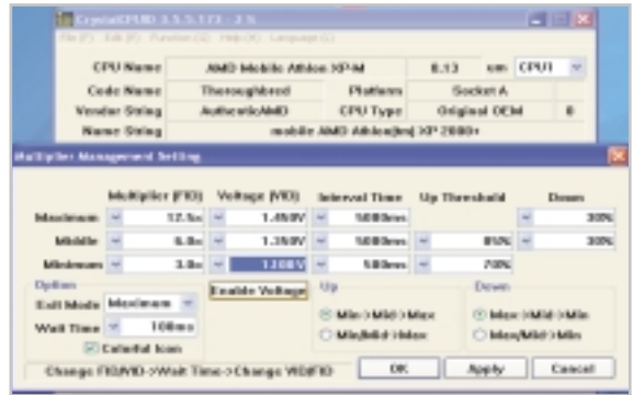
Crystal CPUID: Multiplier Management Setting ile mobil Athlon işlemcisinin frekansını ve voltajını düşürebilirsiniz.
