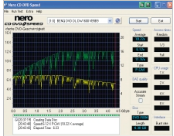
Dinamik hız belirleme: Yeşil ve sarı grafikler yazma sırasında medyanın dönüş hızını görselleştiriyor. Yavaş olanların düzeltme aşamaları olduğu açık.
