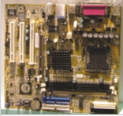
FIC anakart: VIA yonga seti sayesinde AGP 8x ve PCI Express'e uygun.
